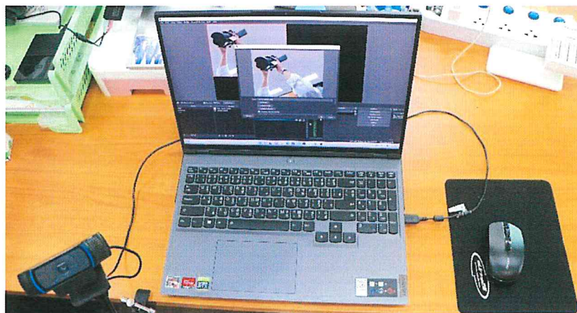
ภาพที่ 3.8 การเชื่อมต่อกล้อง Webcam แบบใช้สาย USB
