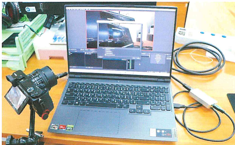
ภาพที่ 3.9 การเชื่อมต่อกล้อง DSLR ผ่าน Capture Card แปลงสัญญาณภาพ
